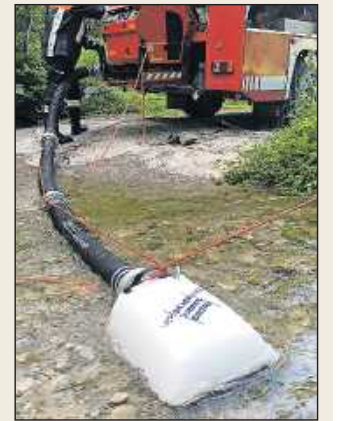
Mit diesen Schwimmsaugern kann die Feuerwehr auch bei Niedrigwasser Löschwasser aus Bächen oder Teichen entnehmen.
